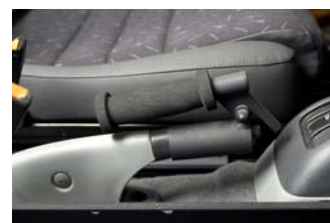
Handbromsfrigörare monterad ovanpå ordinarie handbroms.
