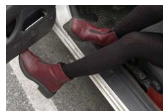
Dörrtröskelns höjd över marken och över golvet i kupén påverkar hur lätt det är att ta sig i och ur bilen.
